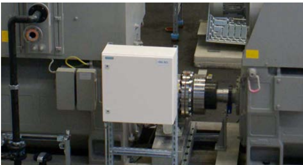
Kein freies Wellenende an Verbindungswelle zwischen Tandemmotoren No free shaft end at connection shaft between tandem motors
