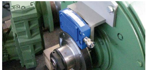
Deutlich längere Lebensdauer des lagerlosen MAG-Systems gegenüber Standard-Drehgebern/The bearing-free MAG system has an extended lifetime compared to standard encoders
