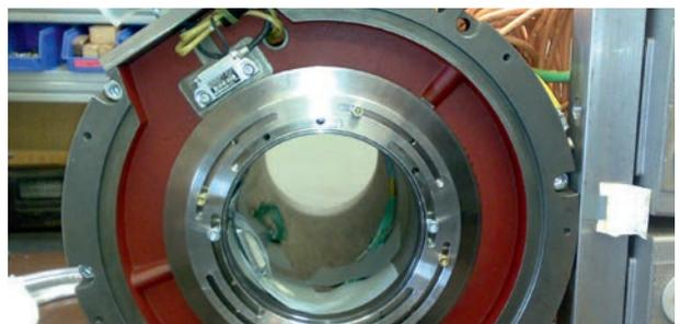
Nachher: Präzise Signale durch Direktanbau des maßgeschneiderten MAG-Systems im Motorengehäuse/After: Precise signals through direct mounting of the customized MAG system in the motor housing
