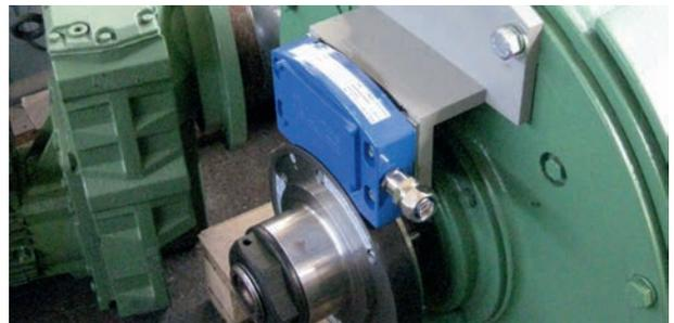
Deutlich längere Lebensdauer des lagerlosen MAG-Systems gegenüber Standard-Drehgebern/The bearing-free MAG system has an extended lifetime compared to standard encoders
