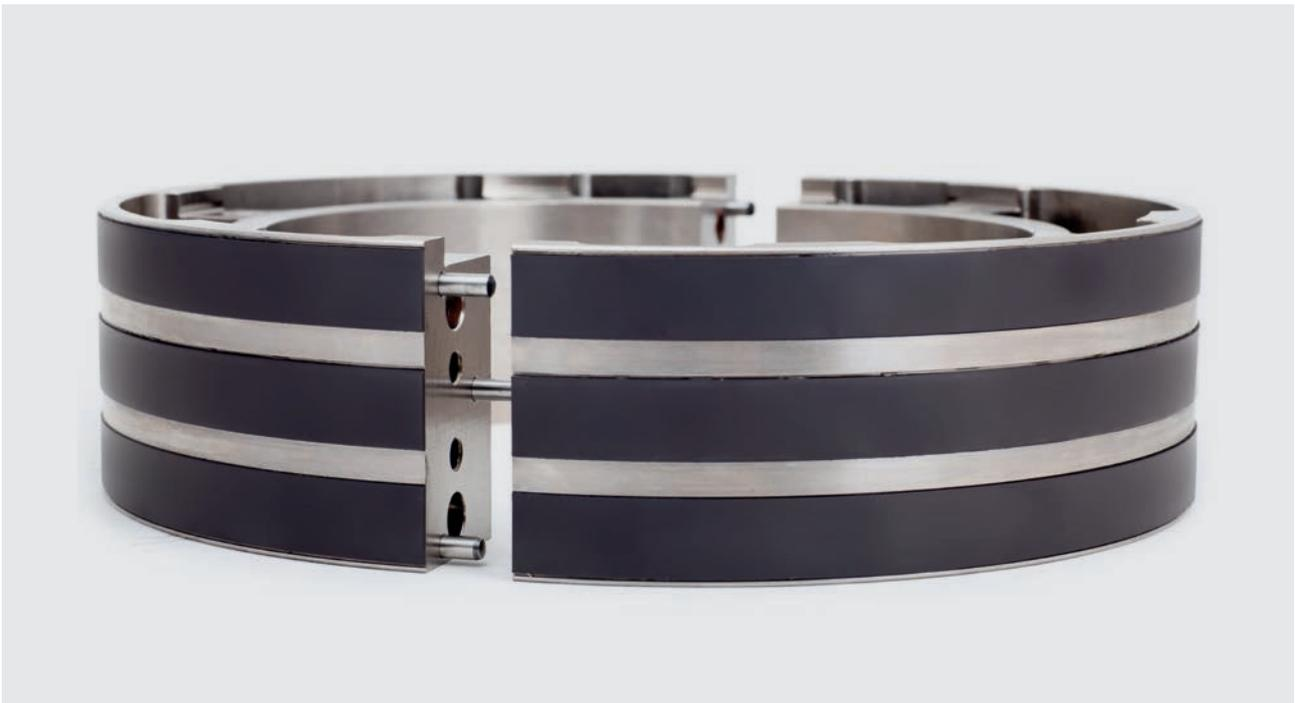
Die mit Schrauben verbundenen Polrad-Hälften werden entweder auf der Welle sicher verklemmt oder an einem Wellenabsatz oder einem separaten Zentrierring verschraubt. Für Anwendungen mit besonders hohen Drehzahlen bietet Hübner eine patentierte, formschlüssige Konstruktion des geteilten MAG-Systems.
