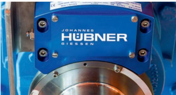
MAG inkl. Abtastkopf mit Klemmkasten für LWL-Anschluss
