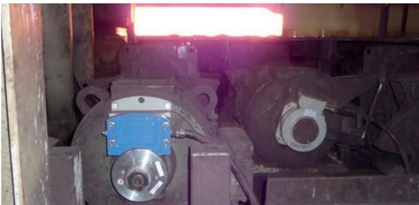
Rollgangmotoren sind extremen Schock- und Vibrationsbelastungen ausgesetzt/Roller table motors are exposed to high shock and vibration loads
